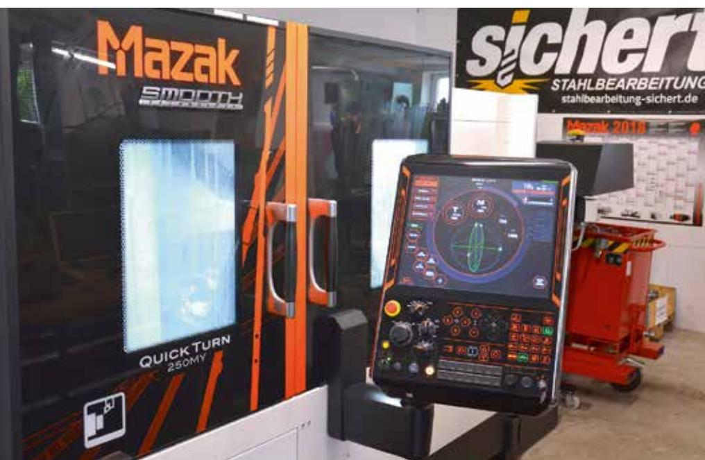
1 Produktivität, die Spaß macht: Mit der Drehfräsmaschine Quick Turn 250 MY hielt bei Metallbearbeitung Sichert auch die auf Werkstattprogrammierung und Industrie-4.0-Unterstützung ausgelegte Smooth-G-Steuerung von Mazak Einzug (© Hanser)
