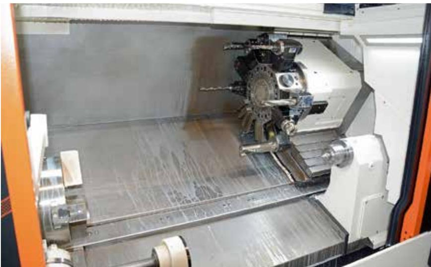
**4** Aufgeräumt und extrem leistungsfähig: Blick in den Arbeitsraum des Drehfräszentrums Quick Turn 250 MY von Mazak mit 1000 mm Spitzenweite, auf der Sichert dank der soliden Konstruktion und ausdauernd kräftiger Direktantriebe am 12er-Revolver problemlos auch mit einem 54er-Vollbohrer zur Tat schreitet (© Hanserl)
